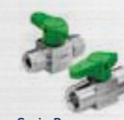
Serie P Macho cilíndrico / Plug valve Pres. max.: 206 bar / 21°C Temp.: -23°C - 204°C
